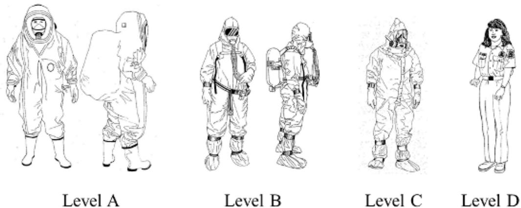
**Abbildung 2.3:** Schutzbekleidung (PPE), abgestuft nach den Empfehlungen der US EPA
