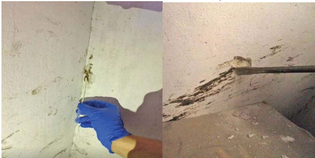
FIGURA 4: TOMA DE MUESTRAS DE SALPICADURAS DE SUSTANCIA NEGRA EN PAREDES INTERIORES, MAREA
