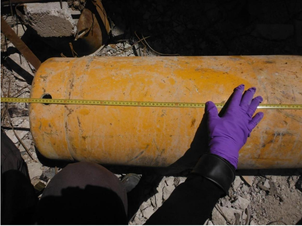
الشكل ٨: قطر قاعدة الأستوانة التي عُثِر عليها بالمكان ٢ حسب المقاسات التي أخذتها بعثة التقصي يوم ٢١ نيسان/أبريل ٢٠١٨. وتطابق الأبعاد أبعاد الأستوانة التي استُخدمت في الهجوم الكيميائي على سراقب يوم ٤ شباط/فبراير ٢٠١٨ (المصدر: بعثة التقصي)
